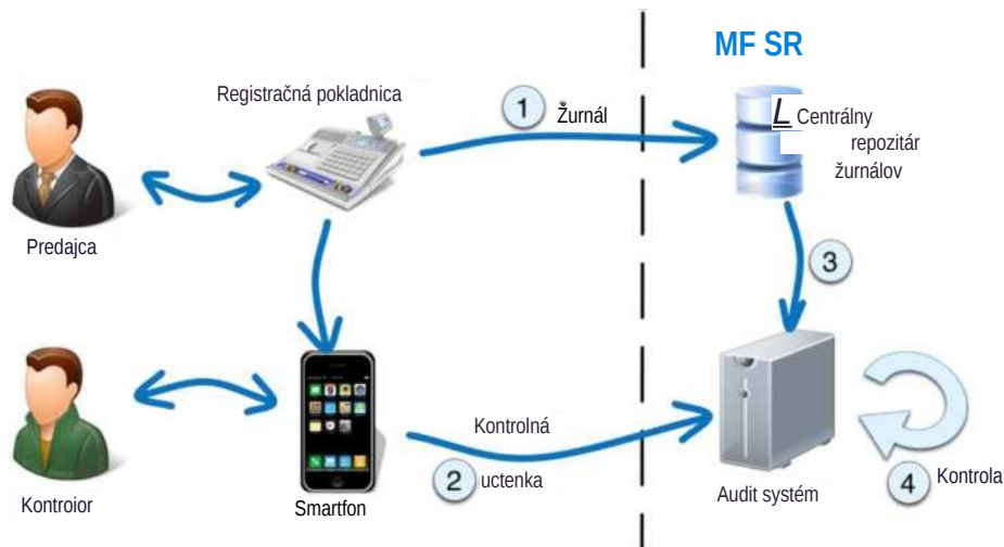
Obrázok 20 Všeobecná architektúra technického riešenia
